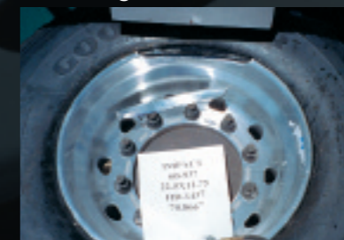
Ruota in alluminio fuso
