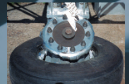
Ruota in alluminio fuso
